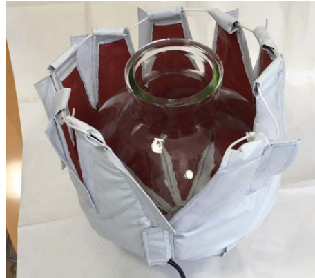
Termocoperta per sfera di vetro Heating Blanket for glass sphere
