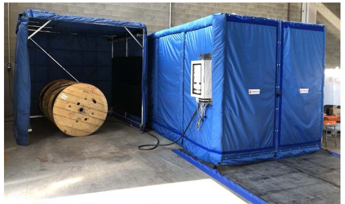
Camere calde per bobine di cavi elettrici Hot box for electrical cable reels
